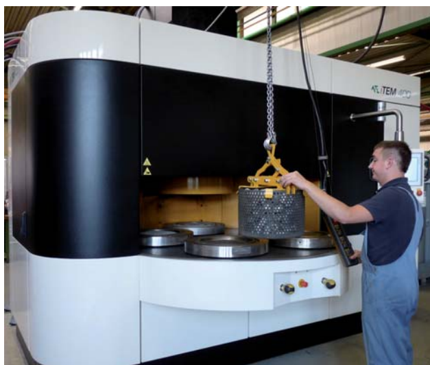
Carregamento da máquina de rebarbamento ITEM 400
