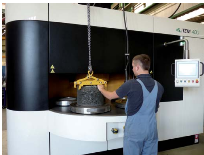
Colocação do material a ser rebarbado sobre o disco obturador
