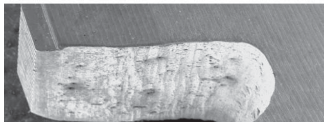
Peça sob microscópio eletrônico de varredura (SEM) antes e após o rebarbamento térmico
