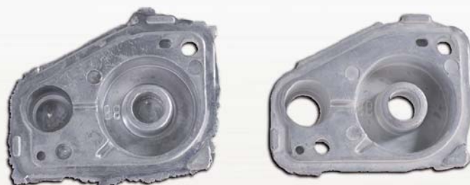
Peça de zinco moldada sob pressão antes e após o rebarbamento térmico
