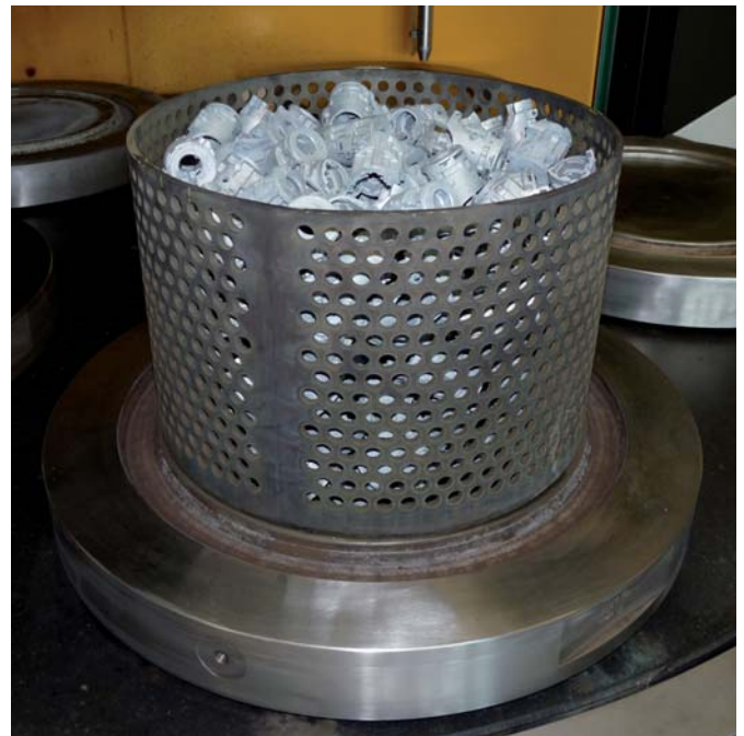
Korb mit Schüttgut für Entgratkammer \varnothing 400 x 300 mm
