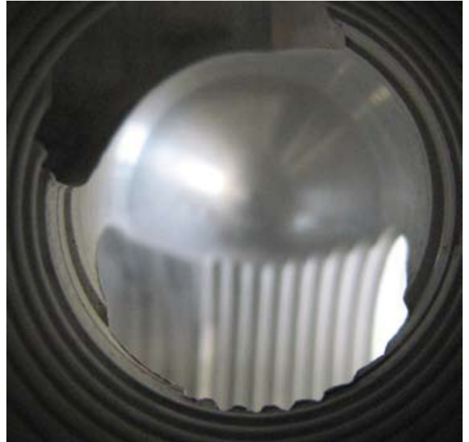
Verteilerblock aus Aluminium, Querbohrung schneidet Gewindebohrung Zeitersparnis gegenüber Handentgraten ca. 3x so schnell.
