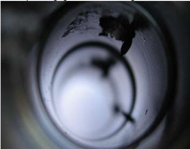
Stahlwerkstück - nach dem Bohren bleibt ein typischer Kronengrat mit Gratkappe stehen. Zeitersparnis gegenüber Handentgraten ca. 2x so schnell.
