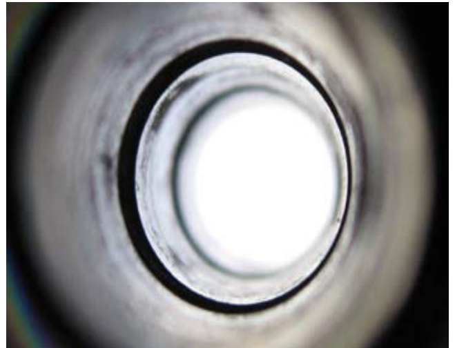
Stahlwerkstück - nach dem Bohren bleibt ein typischer Kronengrat mit Gratkappe stehen. Zeitersparnis gegenüber Handentgraten ca. 2x so schnell.
