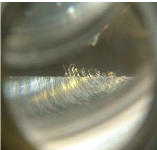
Rostfreier Stahl - feine Fräsgrate , 0,1mm dick, werden beim Handentgraten leicht übersehen. Zeitersparnis gegenüber Handentgraten ca. 10x so schnell.
